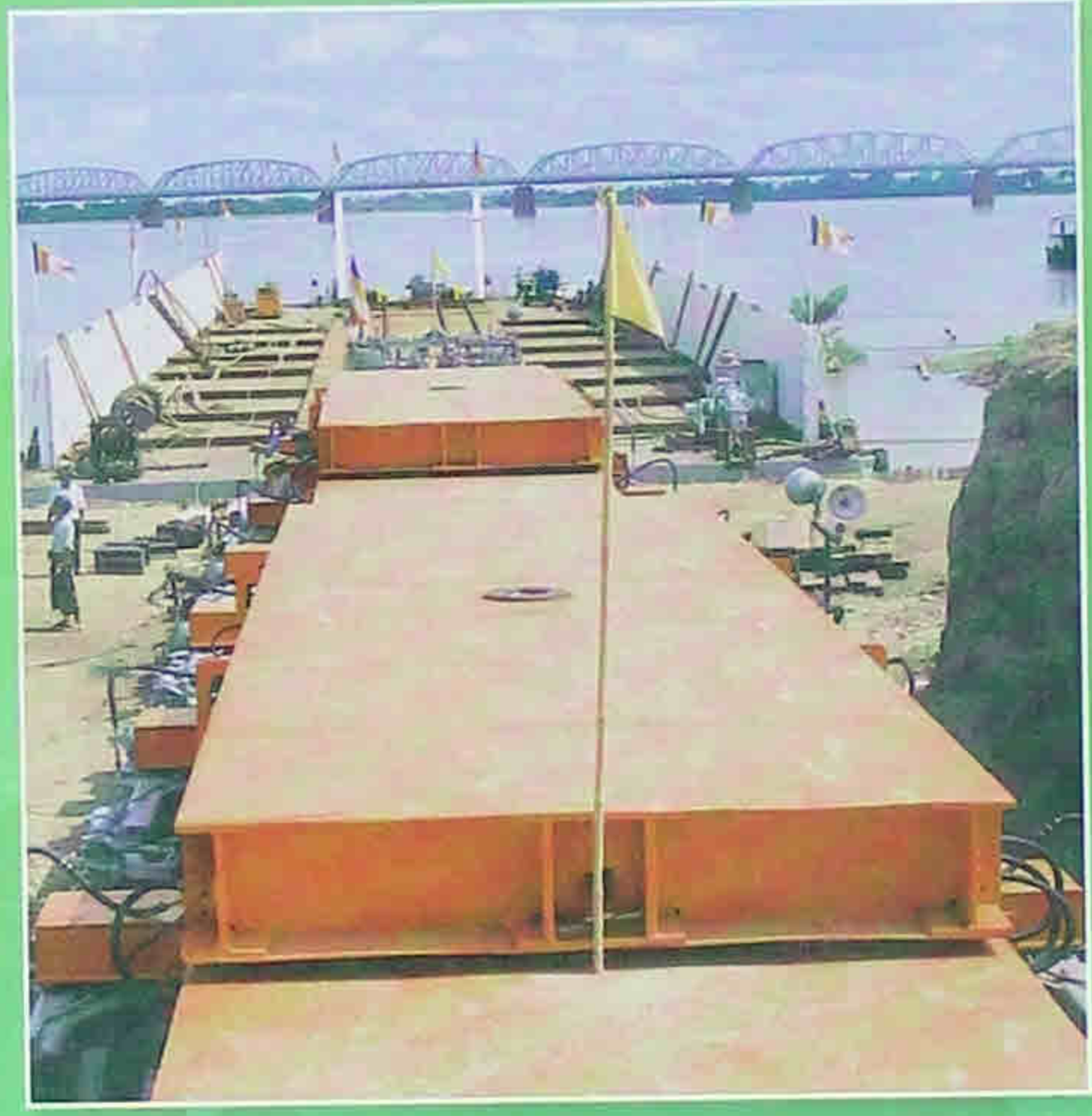
၂၉ - ၆ - ၂၀၀၀ ရက်နေ့တွင် ရထားတွဲ A & B Frahe တွဲရေယာဉ်ဝပ်ကျင်းအတွင်း ရေဖြည့်ထိုင်ထားပုံနှင့် ရထားလမ်း တစ်ဆက်တည်း ခင်းထား၍ ရထားတွဲများအား တွဲရေယာဉ်ပေါ် တင်နေစဉ်
